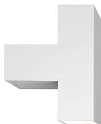
Applique à lumière directe/indirecte. Corps en aluminium extrudé peint. Filtres latéraux en fonte d'aluminium repris à 45° sur contrôle numérique pour un assemblage parfait avec le corps de la lampe. Diffuseurs en PMMA moulé par injection finition photgravée. Attache murale en PA66 moulé par injection. Alimentation multitenion intégrée dans le corps de l'appareil.
